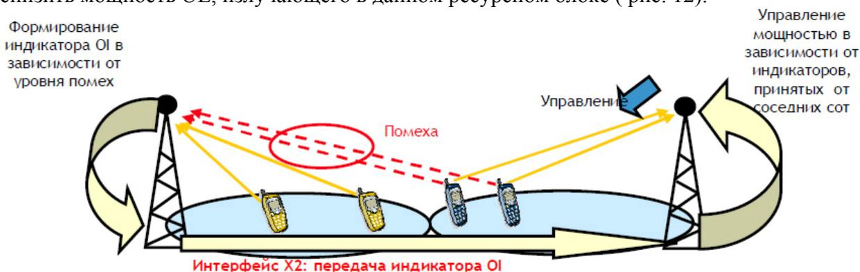
Рис. 12. Управление мощностью соседней базовой станции
