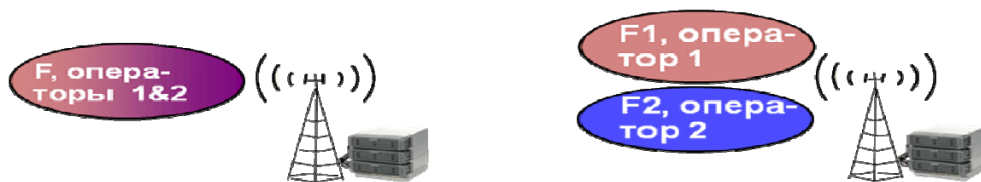
Рис. 7 Переиспользование сайта с совместным использованием спектра и с разделением по частотам
