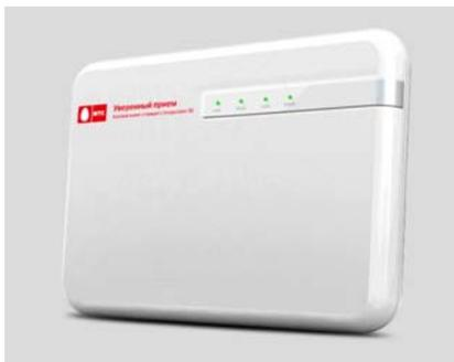
Фемтосота (англ. Femtocell) — маломощная и миниатюрная станция сотовой связи, предназначенная для обслуживания небольшой территории (одного офиса или квартиры). Фемтосота
