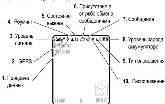
**1. Индикатор передачи данных** - показывает состояние соединения и передачи данных. Индикатор Bluetooth® отображается при активном соединении Bluetooth. Другие индикаторы:
