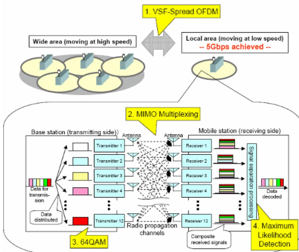
1. Использование Переменного фактора распространения (Variable Spreading Factor) - технология уплотнения с ортогональным частотным разделением кодированных сигналов и использованием переменного фактора распространения (Spread Orthogonal Frequency Division Multiplexing). Технология быстрой пакетной передачи, использующая ту же систему радиодоступа для любых местных условий за счет управления фактором распространения в зависимости от условий в помещении или вне его, а также условий передачи.
